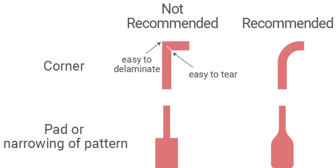
図 4-1 配線のコーナー部分やランド、配線幅を変更する部分の推奨形状
