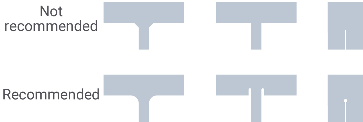
図 6-2 非推奨の外形形状と推奨している外形形状の例
